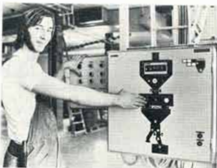
Snart börjar lamporna lysa och siffrorna springa förbi på manöverpanelen när Ove Johansson startar satsningen av torrbländade produkter.
