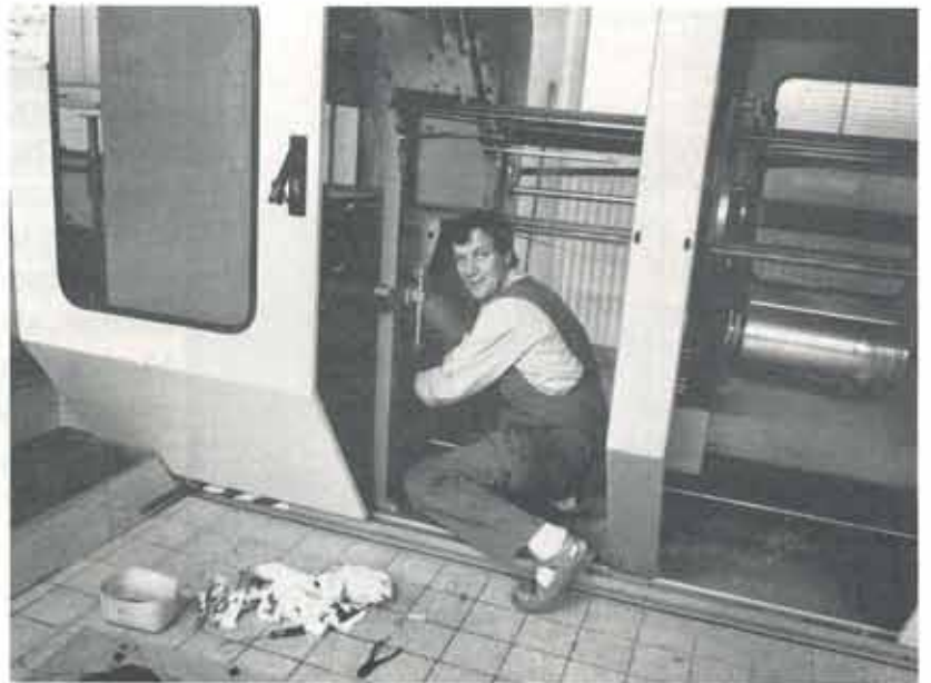
Bengt Söderman byter delar i och smörjer streckfilmsmaskinen till ACMA II .
