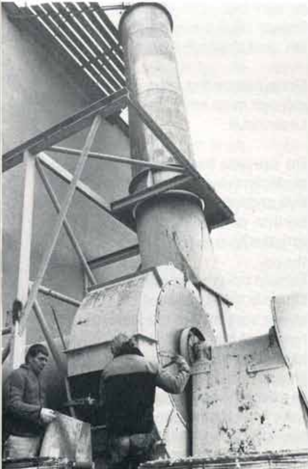
Bengt Söderman byter delar i och smörjer streckfilmsmaskinen till ACMA II .
