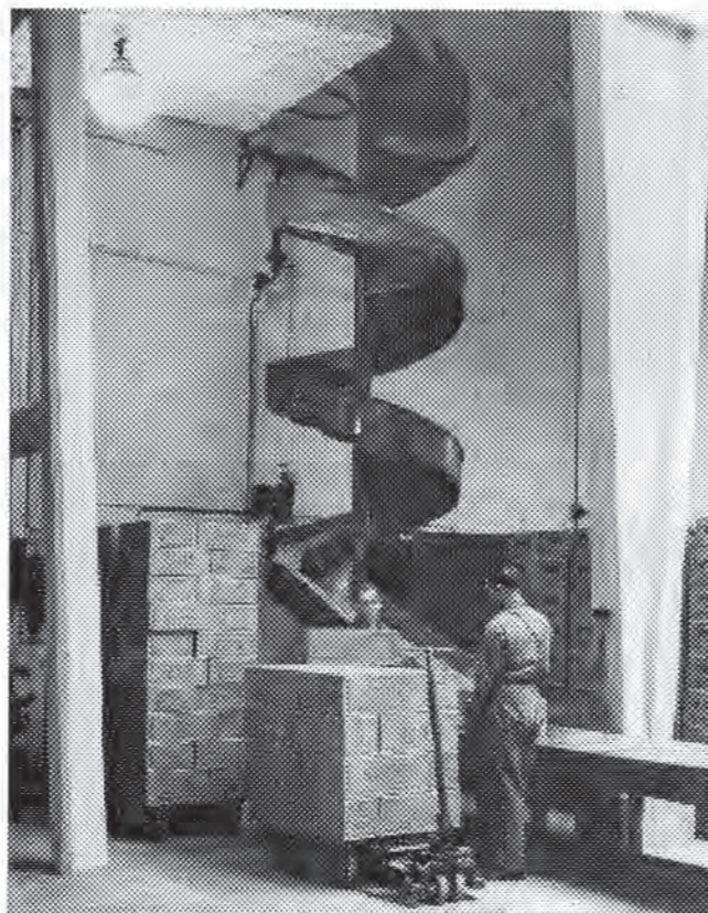
"Slisken" där produkterna kommer ned från transportbandet och lastas på pallar.
