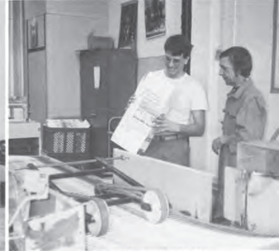
I slutändan kollar TOMMY HOLMER resultatet. Han är något av "uppfinnarjocke" med många belönade förbättringsförslag just på den här maskinen. Här ser han ut att vara nöjd med både limsträngen och med isättning av kragen i kapseln. Th står GERT LARSSON, maskinreparatör på tvålvärd. Han "praktiserar" på sidolimningen för att efter tvålens nedläggning börja arbeta här.
