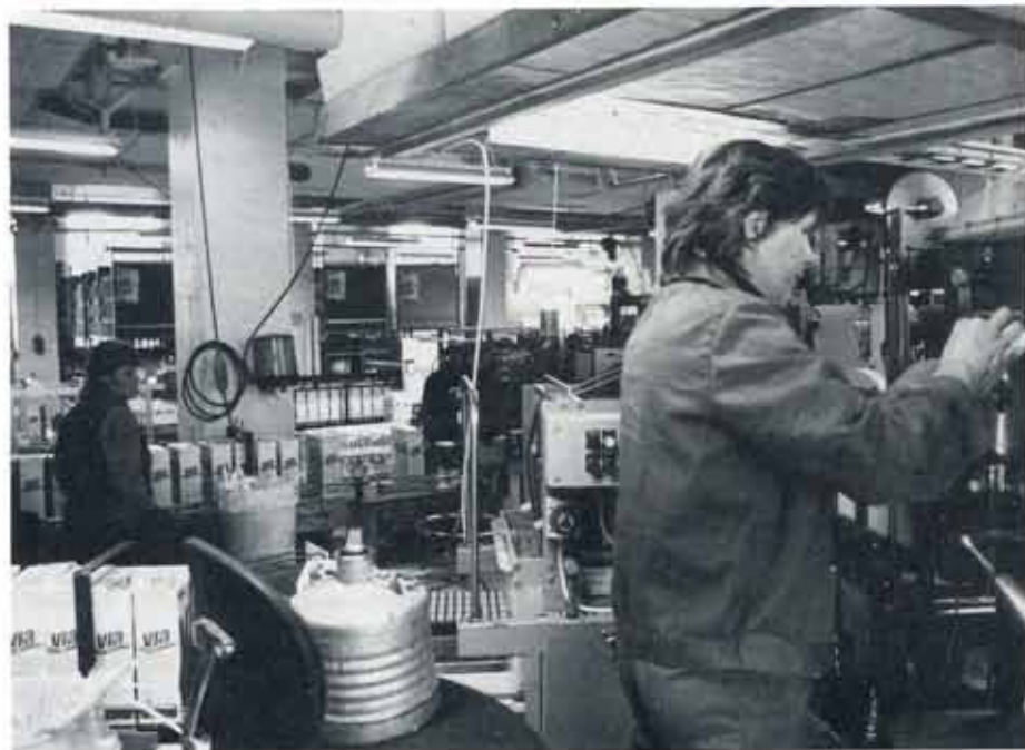
En ny handtagspåsättare till pulverpackningen är installerad och skall tillsammans med den tidigare kunna limma handtag på 100 paket/min. Här serverar Lisa Blomqvist den nya maskinen medan Susanne Smedberg har kontroll över den andra.
